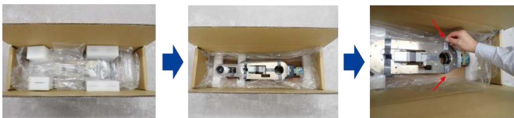
3. 第1軸（M1）のモーター部と第2軸（M2）のモーター部を両手で保持しながら、製品を取り出します。
